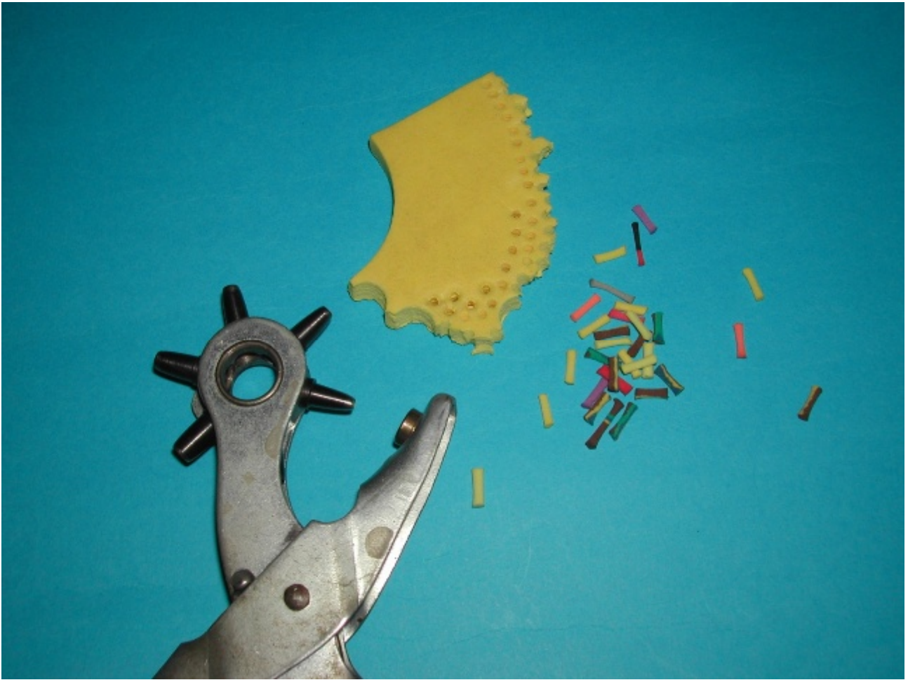
Servendomi di una pinza con cui si praticano i fori nel cuoio, ricavo dei piccoli cilindri da mattonelle di foam.
